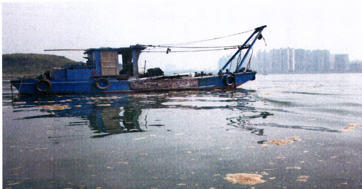
(1) 船舶驾驶台前部船舱明显变形，船舱向右舷方向被炸开。
